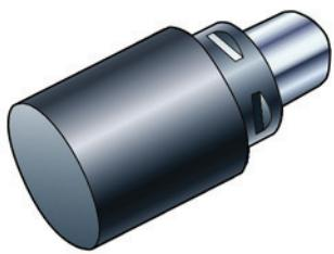
Заготовки с базовыми поверхностями Coromant Capto имеют не подвергнутую термической обработке переднюю часть для того, чтобы заказчик мог придать им любую форму с последующей термообработкой.
