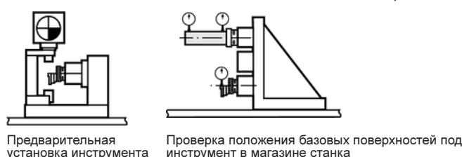
Проверка положения базовых поверхностей под инструмент в магазине станка
